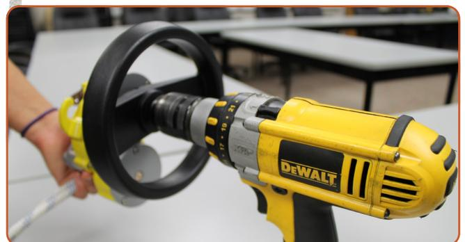
Se usa un eje sobresaliente de 10 mm de diámetro en el núcleo como adaptador de broca. Conecte el taladro para ayudar a controlar el ritmo y/o levantar a la víctima caída. Par mínimo recomendado: 45 nm. Velocidad mínima de rotación: 0-300 revoluciones/min.
